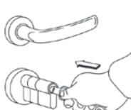
7) I cilindri Securemme sono dotati di camma sporgente, per offrire un migliore ancoraggio in caso di sfondamento. è quindi possibile infilare e sfilare il cilindro della serratura senza interventi distruttivi solo disponendo delle chiavi e ruotando il pomolo.
